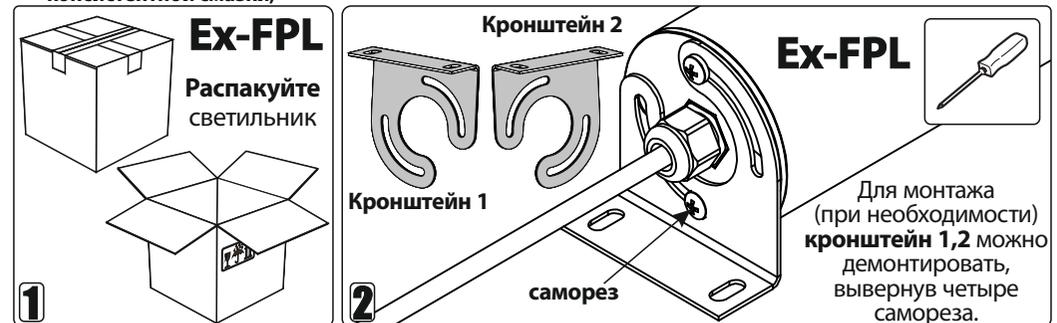
3 Установите кронштейн 1, 2 на монтажную поверхность и закрепите их с помощью винтов, болтов, саморезов (в комплект не входят).
